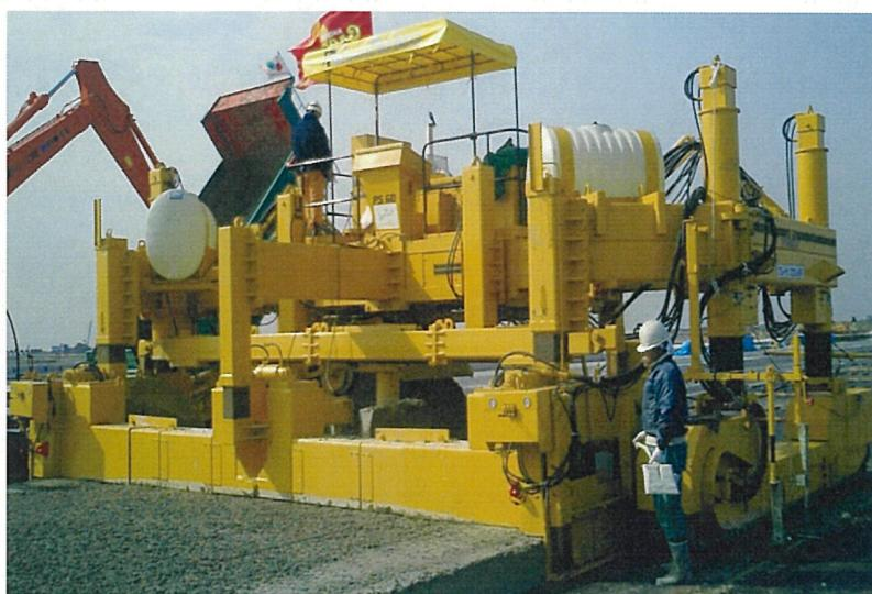
写真3 スリップフォームスプレッダによる下層コンクリート敷均し状況の例
