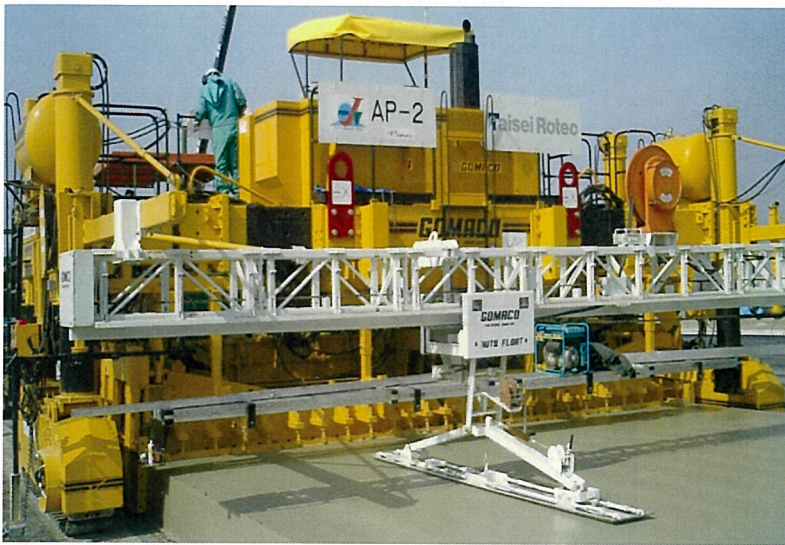
写真7 スリップフォームペーバによる成型仕上げ状況の例
